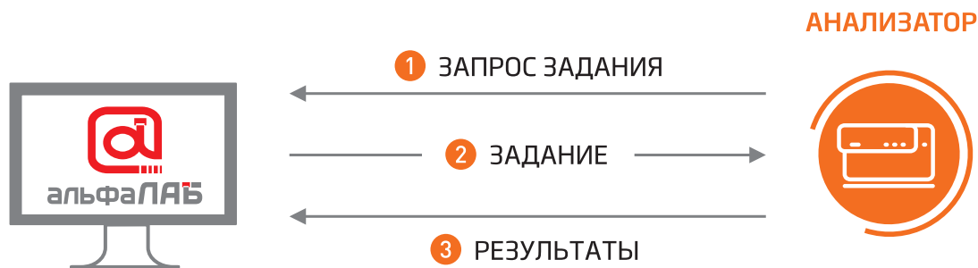
Рис. 3. Взаимодействие анализатора с ЛИС «АльфаЛАБ» в двунаправленном режиме с автоматическим запросом задания
