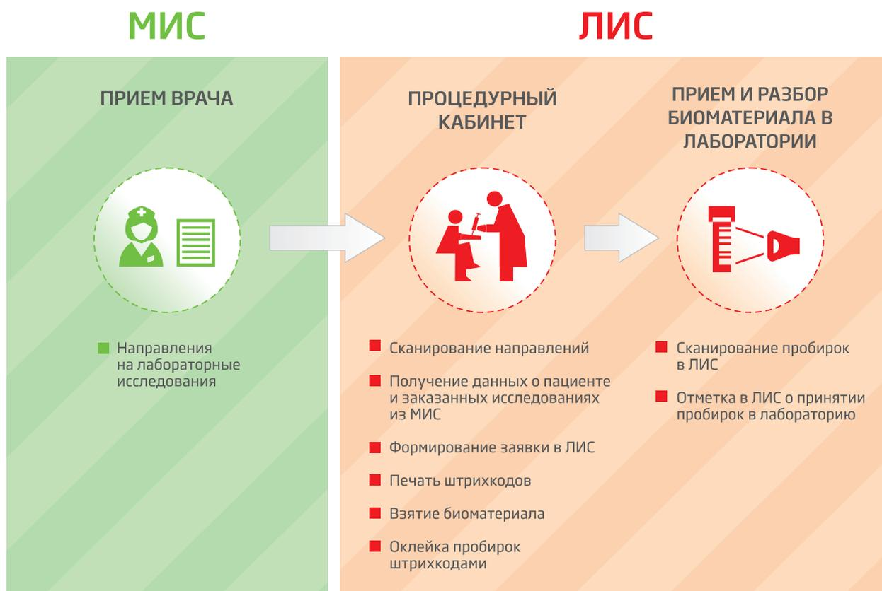
Рис. 2. Схема организации процесса информатизации преаналитического этапа в случае, если в процедурном кабинете установлен ЛИС
